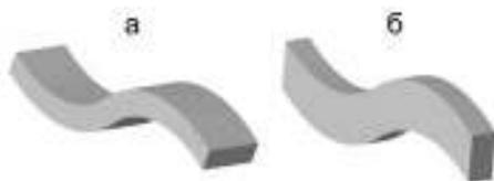
Рисунок 2 - Схематическое изображение изгибных колебаний балки по толщине (а) и по ширине (б) для второй моды стоячих волн
